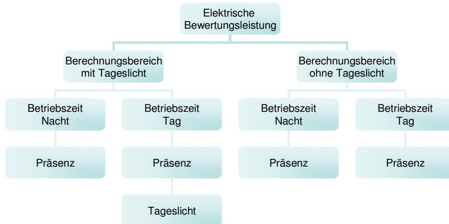
Abbildung 2.22: Rechenschema Energiebedarf Beleuchtung (DIN 18599-4, 2007)
